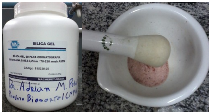
Figura 9: Material da fração Acetato de etila com Sílica gel para coluna cromatográfica.
