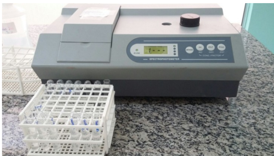
Figura 15: Espectrofotômetro utilizado para verifica absorvância dos inoculos bacterianos.
