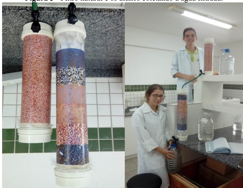
Figura 3 - Filtro natural e os alunos coletando a água filtrada.
