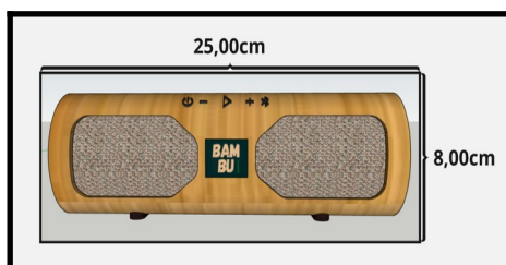
Figura 10: Imagem do protótipo da caixa de som desenvolvida no software Sketchup.
